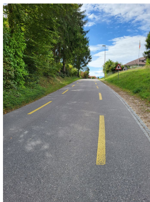
Beispiel in Grossaffoltern (Ammerzwilstrasse), mit Radstreifen und Bankett, auch als schmaler Fussweg genutzt (beleuchtet) (Bild: bfm).
